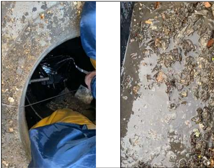
Bild 4-7: Messen des Schlammspiegels mit dem Zollstock (links); ausgepumptes Sediment (rechts)
