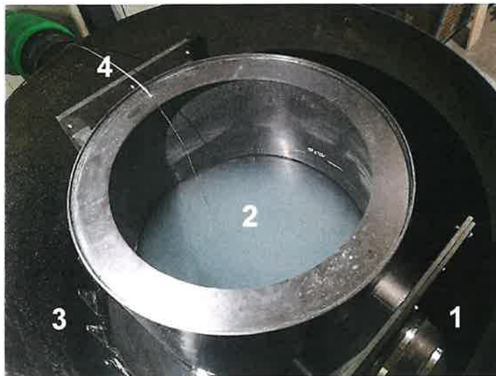
Abb. 1: Blick in den Hydroshark mit den einzelnen Komponenten: Zulauf (1), Absetzbereich (2), Zackenwehr (3) sowie Auslauf (4).
